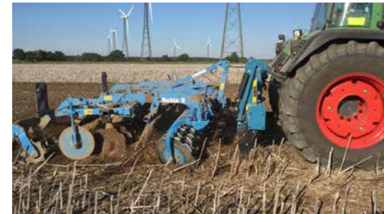
▲ Culter in Kombination mit einer Scheibenegge.
