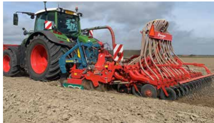
▲ Culter in Kombination mit einer Kreiselegge
