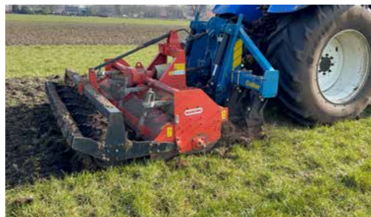
▲ Culter in Kombination mit einer Kreiselegge auf schwerem Boden.
