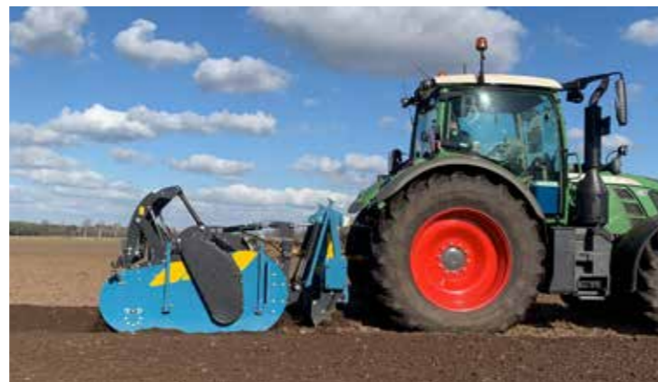
▲ Culter in combinatie met spitmachine.
