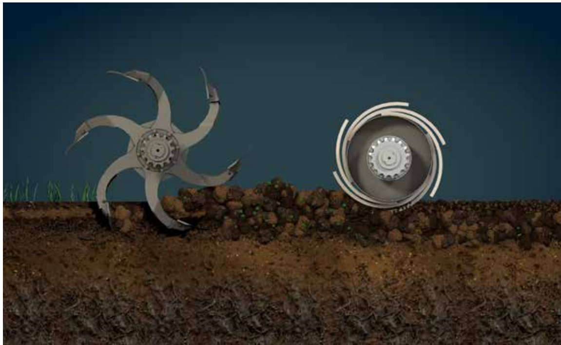
Bêcher avec rouleau émetteur motorisé
